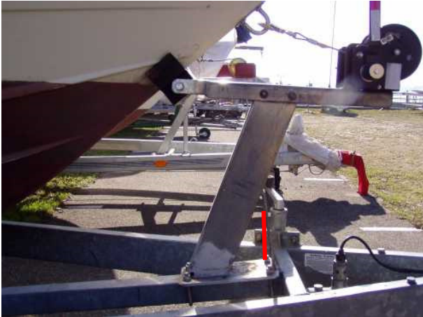
Das Widerlager dieser Bugstütze befindet sich bis zur halben Höhe der Stütze
