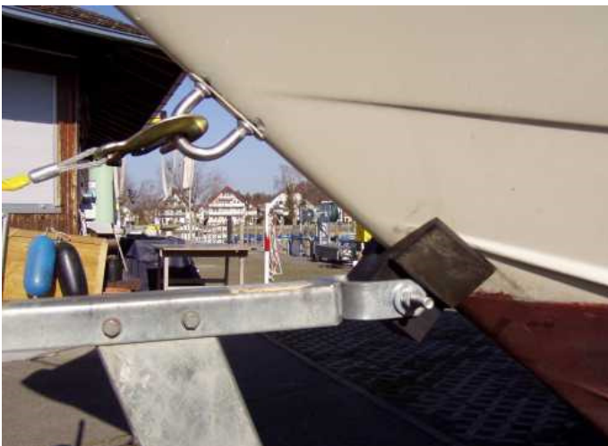
Aufgrund der massiven Bauweise offensichtlich ein leistungsfähiger Zurrpunkt/Bug Öse.
