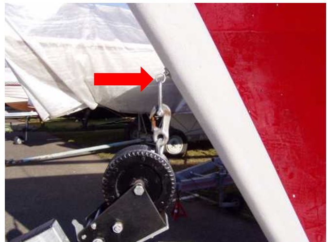
Festigkeit der Zurrpunkte sorgfältig prüfen. Hier: höchstwahrscheinlich ein ungeeigneter Zurrpunkt/Bug Öse.
